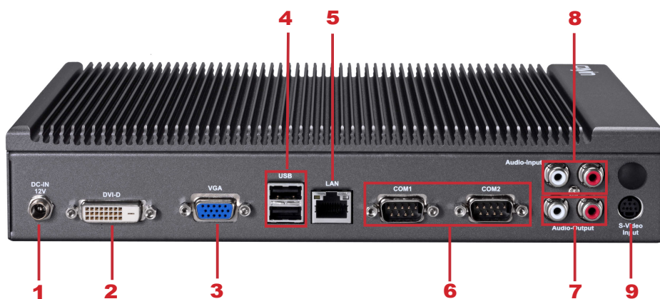
1. Conector de alimentación 2. DVI 3. VGA 4. USB×2 5. Ethernet LAN 6. RS-232x2 7. Salida de audio 8. Entrada de audio 9. Entrada de S-Vídeo
