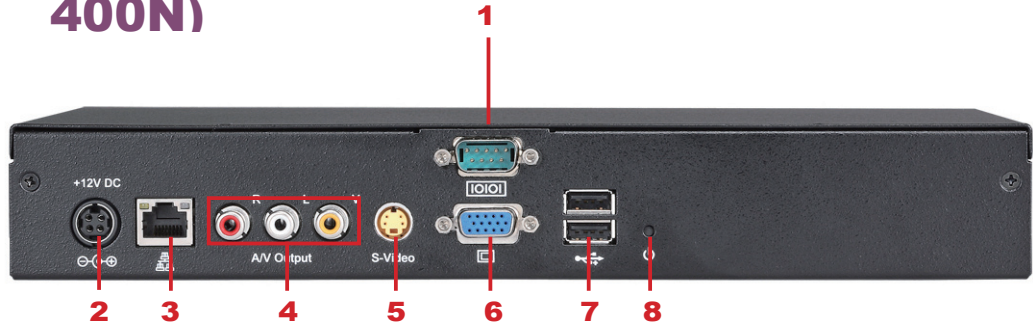
1. RS-232 2. Conector de alimentación 3. Ethernet 4. Salida de AV 5. Salida de S-Video 6. Conector VGA (Output) 7. Conector de USB 8. Alimentación
